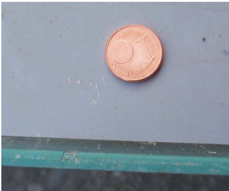
Obr. 11: NOEboard umožňuje zvoliť oveľa menšiu škáru medzi rámom panela a plášťom ako pri bežných preglejkách
