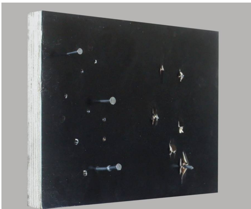
Obr. 7: Plášť z preglejky sa na druhej strane vyštíepi. Cez otvory po klincoch sa do preglejky dostáva vlhkosť a začne napúčať.
