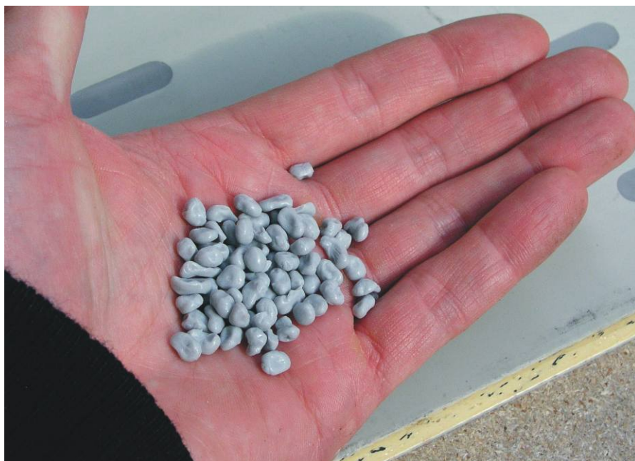
Obr. 17: Výplňová hmota - šedý granulát do tavnej pištole pre opravu povrchu NOEboard
