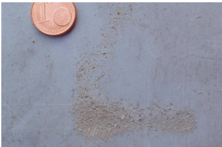
Obr. 13: Poškodenie povrchu NOEboard ponorným vibrátorom
