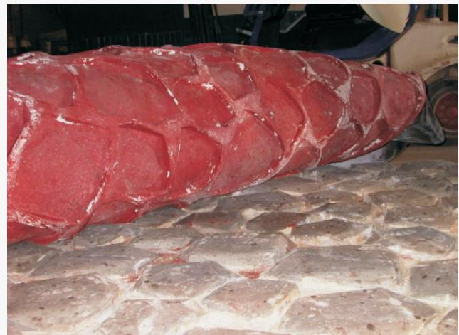
Dve matrice vložené do ocelového debnenia vytvorili odebňovací element, pomocou nich bolo vyrobených 220 betónových prefabrikátov pre nábrežný mûr.
